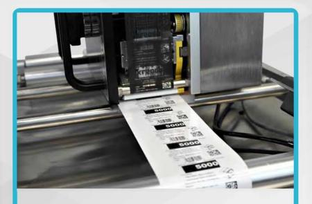
Una amplia gama de codificadores de transferencia térmica (TTO) especialmente indicadas para la impresión sobre embalajes flexibles y etiquetas.
