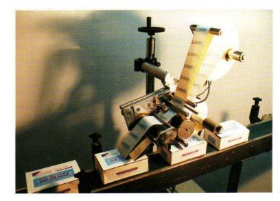
★ Bandejas con cierre de garantía. Se necesita una mesa soporte, 2 cintas transportadoras larerales, cabezal etiquetador y sistema de terminación de aplicación etiqueta a envase. Podría disponer de un marcador (para reimprimir las etiquetas) y mesas de alimentación y recogida.
