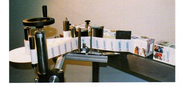
LOS DISPENSADORES SEMIAUTOMÁTICOS DE ETIQUETAS DE ESPALLARDO, S.A., diseñados para mejorar la eficacia en la aplicación manual de etiquetas, proporcionan un suministro constante al operario.
