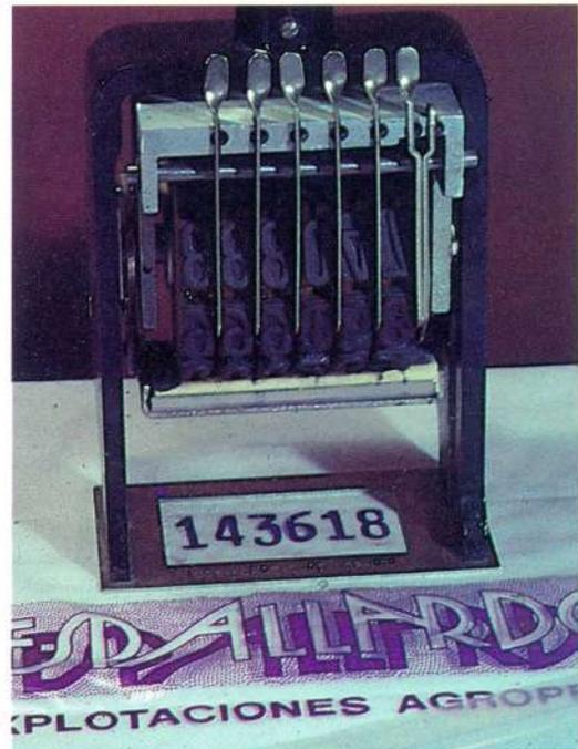
Ref.º 263. NUMERADOR ELECTRONEUMÁTICO de 6 cifras de 25, 18, 12 ó 10 cms. de altura. Puede marcar a voluntad una o dos veces el mismo número con toda nitidez y precisión. Se suministra con anclaje para adosarlo a líneas de envasado donde actúa automáticamente mediante final de carrera. También se puede acoplar en una mesa para numerar cajas o sacos vacíos mediante pedal o pulsador.
