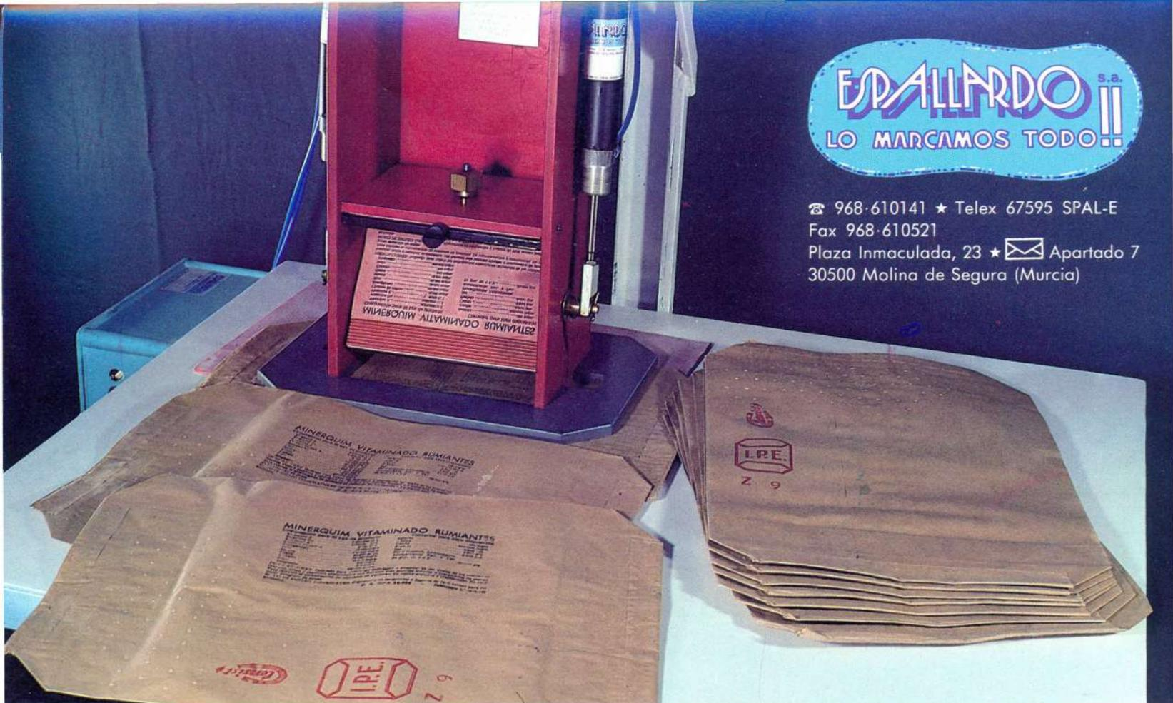
La PRENSA ELECTRONEUMÁTICA marca automáticamente ella sola, sincronizada con ensacadoras de válvula, encartonadoras o cualquier otra máquina o línea de envasado, ya que se puede regular a voluntad su velocidad de impresión.
