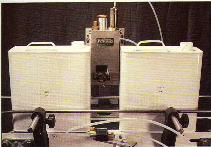
**FUNCIONAMIENTO:** Electroneumático (por fotocélula o por microeléctrico) o neumático (por final de carrera).
