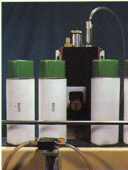
Se suministra, si lo desea, montado en un anclaje que facilita el acondicionamiento para cualquier tipo de marcaje, ya que permite, cómodamente, variar la altura del codificador para marcar a la perfección objetos por grandes o pequeños que sean. Igualmente sirve para desplazar el impresor sobre la cinta transportadora, con lo que no hay problema para codificar los objetos si pasan más o menos cerca del borde de la cinta.
