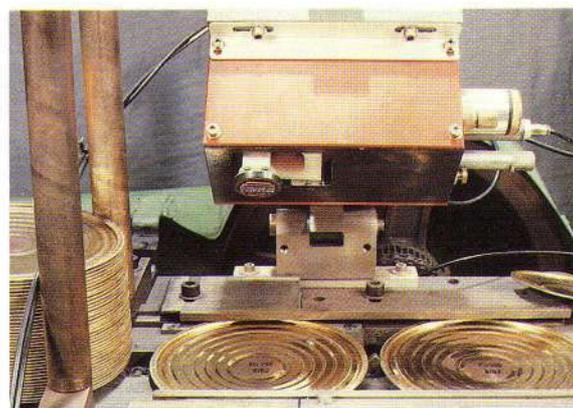
Encima: cabezal impresor de Espal Coder adaptado especialmente para marcar tapas de hojalata, en la misma troqueladora, automáticamente.
